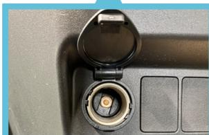
シガーソケットにプラグを挿してモニターの電源取得完了
