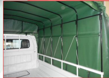
パイプステーキで骨組み（丸棒）を支えます。
